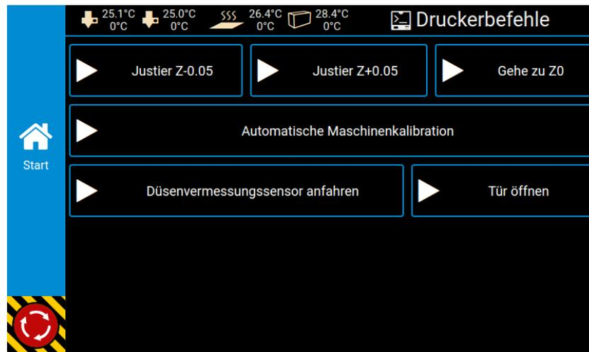
Die Düse sollte mittig oberhalb des Messingsensors stehen bleiben. Sollte die Düse außermittig über den Sensor stehen, muss die Position im Webinterface (siehe zudem Kapitel IP-Adresse) angepasst werden. Das Menü finden Sie im Bereich Druckereinstellungen.
