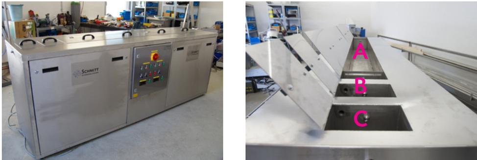
Schmitt Ultraschalltechnik entwickelt auch Sondersysteme nach Kundenvorgaben. Das links abgebildete System wurde zur Endloseinigung von Drähten gebaut. Die drei Kammern dienen zur Reinigung (A), Spülung (B) und Trocknung (C)
