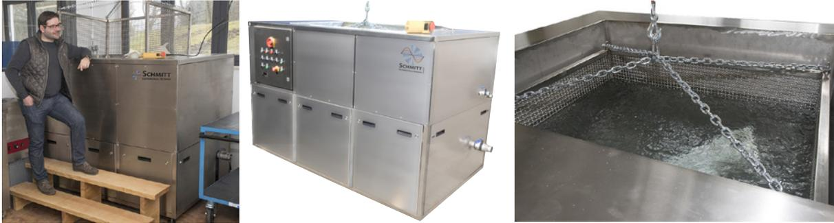
Schmitt Ultraschalltechnik hat anwendungsspezifische Systeme zur Entstützung großvolumiger Fortus 900 FDM-Drucke und großformatiger Polyjetdrucke entwickelt, gebaut und installiert.
