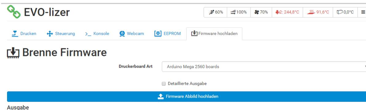
Das Update startet nun automatisch. Warten Sie, bis in der Ausgabe die Zeile *Firmware-Upload beendet* erscheint. Der Drucker braucht noch einen Moment, bis die Steuerung wieder hochgefahren ist. Er kann wieder verwendet werden.
