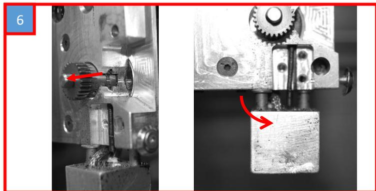
Weiters kontrollieren Sie bitte im **kalten Zustand** alle 3-4 Tage, ob die Schrauben des Alublockes am Extruderkopf fest angezogen sind. Aufgrund schneller Bewegungen und Temperaturexpansionen besteht die Möglichkeit, dass sich diese Schrauben lösen, was zu einer Qualitätsminderung führen kann. Diese Schrauben mit einem geeigneten Werkzeug, bei Betriebstemperatur, anziehen.
