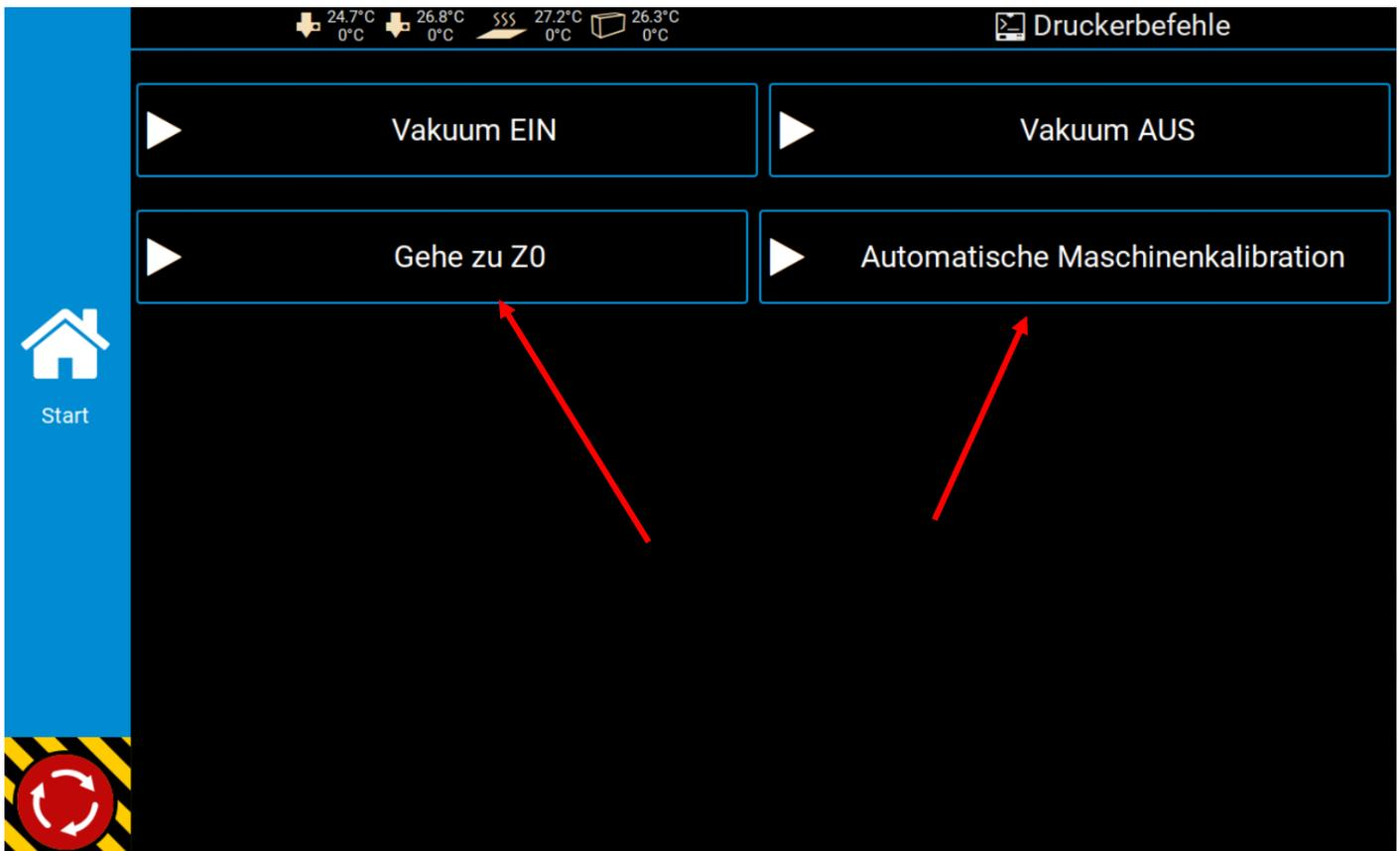
Unter „Druckerbefehle“ wird die Vermessung mit dem Befehl „Automatische Vermessung“ gestartet. Der FFF-Drucker erwärmt und fährt mehrere Punkte auf dem Druckbett ab. Vergewissern Sie sich, dass die korrekte Druckfoliendicke im „EEPROM“ unter „Einstellungen“ eingetragen ist! Je nach Softwarestand können die Befehle abweichen. Vor jedem Druckstart wird über den G-Code (FFF File) eine automatische Vermessung durchgeführt.
