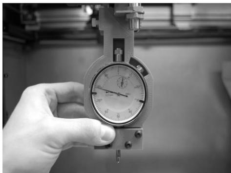
(5) Mit dem im Zubehörkoffer beiliegendem Sechskantschlüssel anschrauben, bis die Messuhr von selbst hält.
