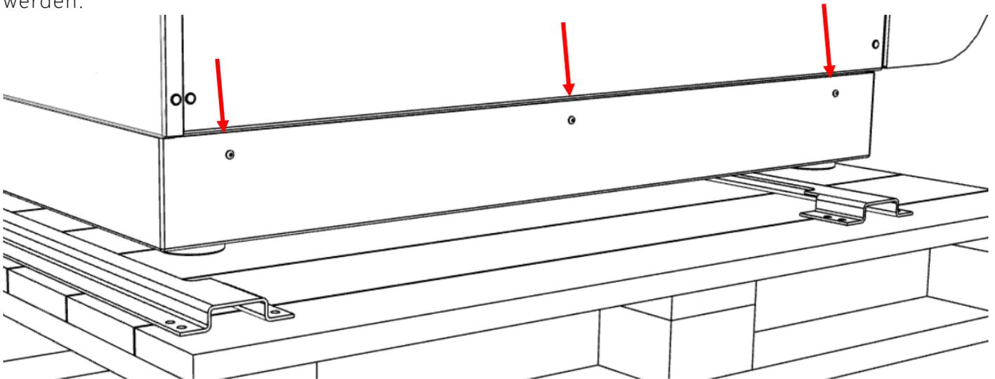
Wenn der EL-102 an seinem Aufstellungsort steht können Sie die restliche Verpackung abnehmen. Bevor Sie loslegen müssen noch Griffe sowie Display montiert werden. Das Display wird bei der Einschulung und Inbetriebnahme von unseren Technikern montiert!
