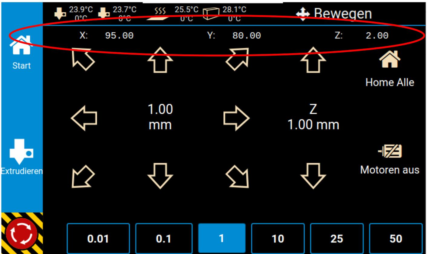
Sollte die Druckbettebenheit mehr als 1,5mm Unebenheit aufweisen, wird der automatische Vermessungsprozess abgebrochen und eine Fehlermeldung wird angezeigt. Bei einem defekten Sensor wird ebenso der Druckprozess abgebrochen. Betätigen Sie den Softwarenotaus nach einem Abbruch und fahren Sie mit der Anpassung und Kontrolle fort.
