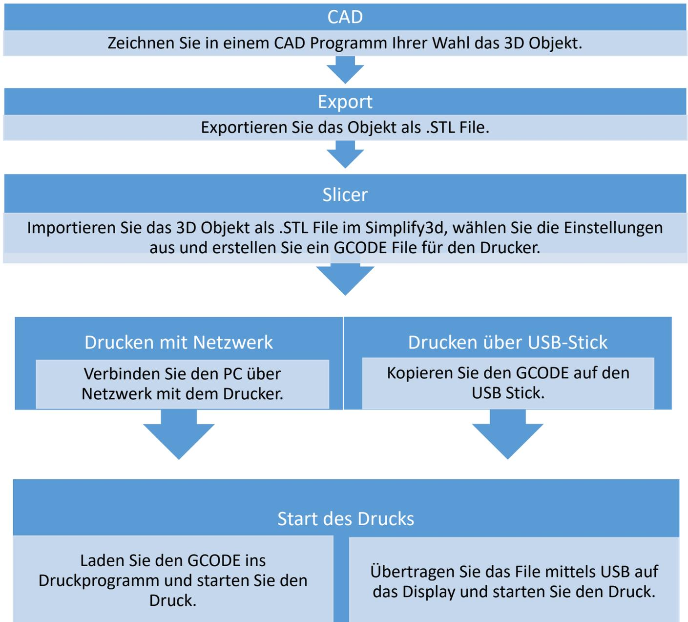
Wählen Sie auf der linken Seite des Displays das gewünschte File unter „G-Codes“ aus und starten Sie den Druck mit „Drucken“. Das Heizbett wird auf den zum Material passenden Sollwert (welcher zuvor in Simlify3D zugewiesen wurde bzw. hinterlegt ist) aufgeheizt. Anschließend heizen die Düsen auf den zum Material passenden Sollwert auf. Nach dem Aufheizen beginnt der Druck.
