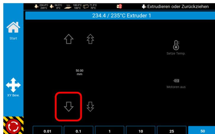
8. Kontrollieren Sie, wie weit der FFF-Drucker das Filament einzieht/extrudiert – die Nachfolgende Darstellung zeigt, dass der FFF-Drucker das Filament zu wenig einzieht/extrudiert, somit die Extrusionsmenge nicht korrekt ist.
