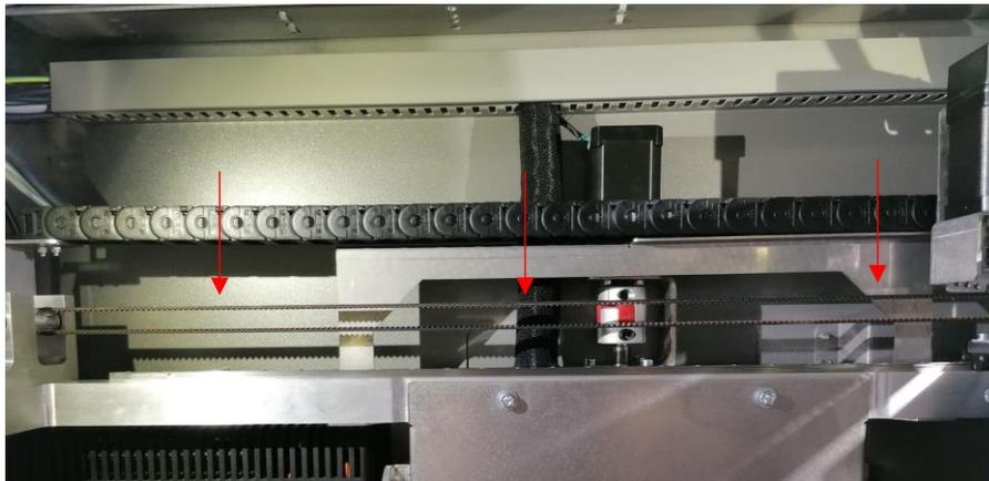
Führen Sie eine Sichtprüfung durch. Die Riemen sollten nicht durchhängen. Obere und untere Riemen sollten annähernd den gleichen Abstand über die gesamte Spannweite aufweisen.
