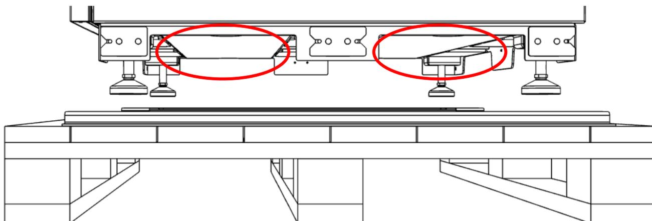
Wenn der Drucker seinen Aufstellungsort erreicht hat müssen die Füße justiert werden, damit der Drucker bestmöglich sicheren Stand erreicht. Anschließend können Sie die Abdeckungen montieren. Wenn die Abdeckungen am Drucker angebracht sind, kann dieser nicht mehr bewegt werden.
