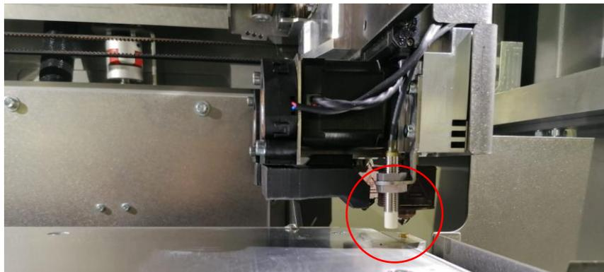
„Homen“ Sie Ihre Maschine und fahren Sie danach vorsichtig manuell, über Befehl „Bewegen“, mit der Düse über den Messingsensor. Notieren Sie sich den X und Y Werte It. Display für die Anpassung im Webinterface.
