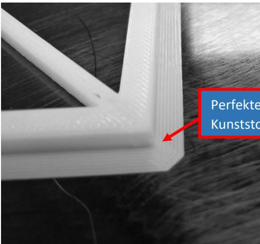
Die Druckbahnen zeigen einen ovalen Querschnitt, der Abstand zwischen den Bahnen ist nicht zu sehen. **Einstellung richtig.**
