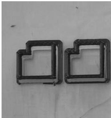
Wenn Extruder korrekt eingestellt sind, liegen die Layer (Bahnen) bei dem Testobjekt genau übereinander. Wenn dies nicht der Fall ist, müssen Sie die Einstellungen korrigieren.
