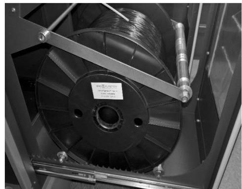
10. Schieben Sie das Filament so lange in den PTFE Schlauch, bis ein Widerstand spürbar ist.
