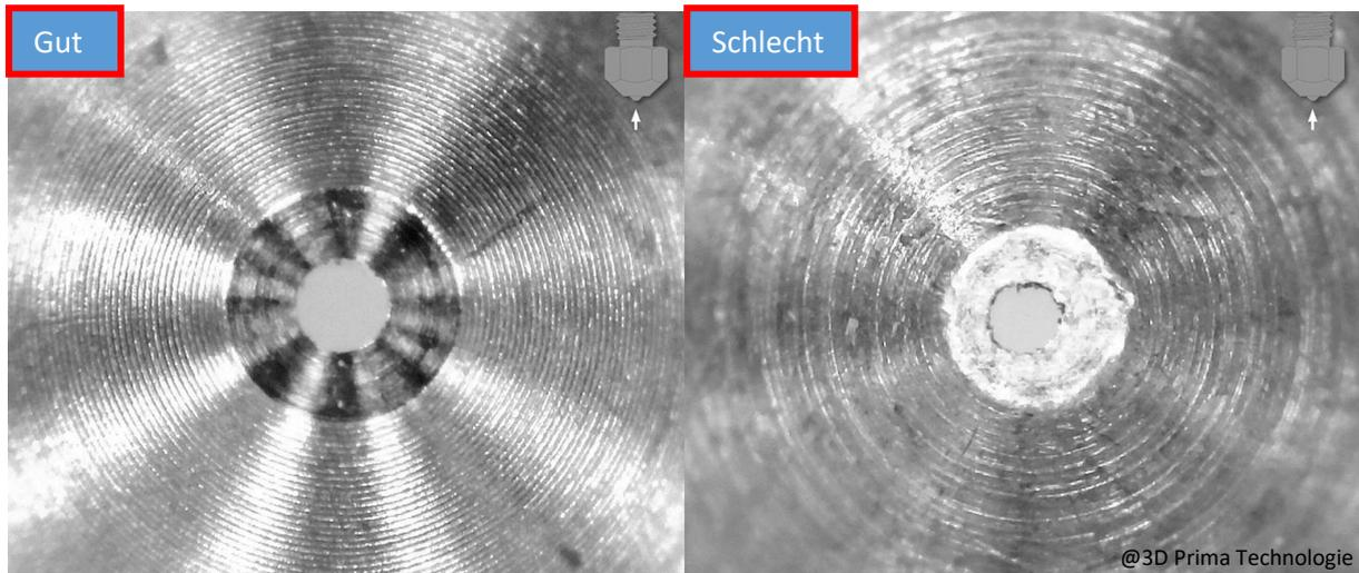
Eine „verschlossene“ Düse muss gewechselt werden,
