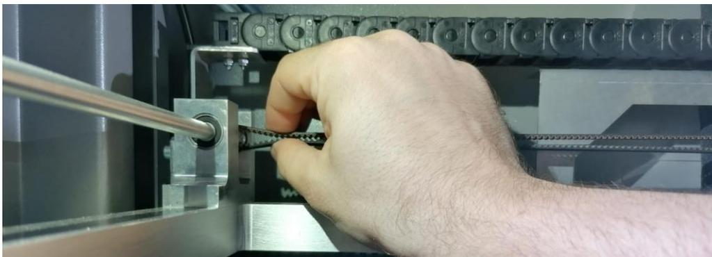
Führen Sie eine Kraftprüfung wie im Bild oben durch. Die Riemen für X und Y Antrieb sollten sich mit „nicht zu starker Handkraft“, ca. 2cm vom Lager entfernt, zusammendrücken lassen. Zu stark eingestellte Riemen führen zu einem Maschinenschaden, wobei zu schwach gespannte Riemen im schlimmsten Fall ein schlechtes Druckbild bzw. Versatz beim Drucken führen kann!
