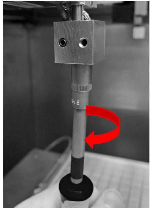
Schrauben Sie die neue Düse gegen den Uhrzeigersinn an. Bei einem Düsensystem mit Heat-Brake muss der PTFE-Inliner mitgetauscht werden!
