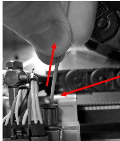
Vorheriges Filament entfernen, um ein Verkleben mit dem neu eingelegten Filament zu verhindern.
