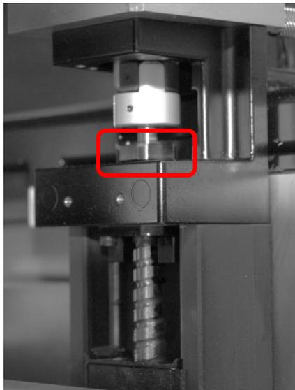
10. Setzen Sie den Gabelschlüssel an den Vierkantblock unter dem Motor der Z-Achse an und verfahren Sie mit „Bewegen“ in Z- bzw. Z+ (je nach Schrägstellung), um den Drucktisch neu auszurichten.
