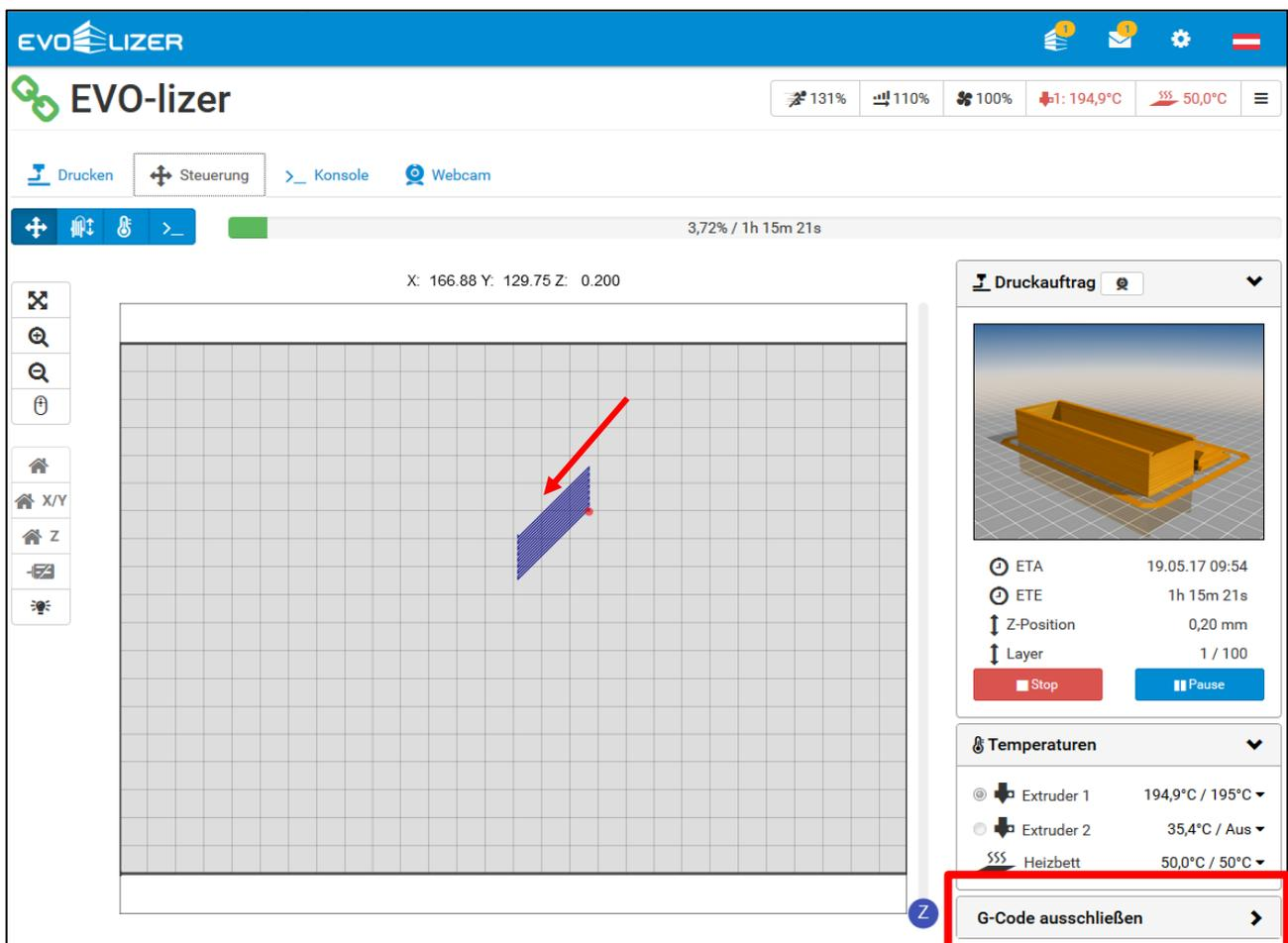
Weiters ist es Ihnen mit „*G-Code ausschließen*“ möglich, direkt im Druck einzugreifen und Bereiche, welche nicht benötigt werden auszuschließen bzw. auszublenden. Der EL-102 FFF-Drucker ignoriert hiermit alles was sich innerhalb dieses ausgeschlossenen Bereiches liegt und fährt diese Position nicht mehr an.
