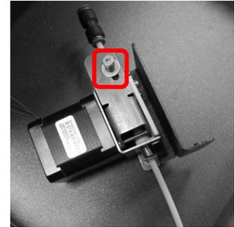
1. Durch Öffnen des Antriebsrades wird Druck vom Filament genommen. Versuchen Sie nach dem Öffnen, das verstopfende Filament zu entfernen.
