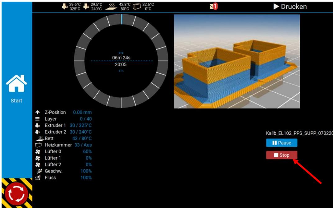
Der Druck kann an dieser Stelle ebenso gestoppt oder pausiert werden. Diese Optionen sollten aber nur im Notfall eingesetzt werden! Nach einem „Stop“ ist der Druck beendet und kann nicht mehr fortgesetzt werden.
