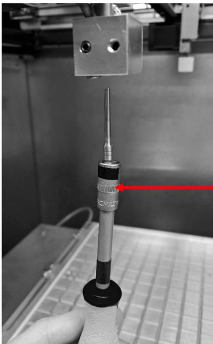
Verwenden Sie, wie in den Bildern gezeigt, einen Steckschlüssel oder ein ähnliches Werkzeug. Verwenden Sie kein Werkzeug mit einem langen Hebel, wie zum Beispiel eine Ratsche. Die Düse darf nicht zu fest angeschraubt werden, da ansonsten das Gewinde beschädigt wird.
