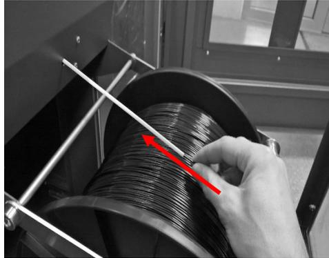
11. Wählen Sie in der Software den Button „*Filament Einlegen*“ und folgen Sie den Anweisungen am Display.
