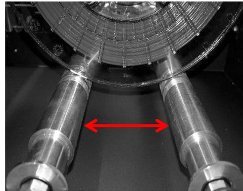
9. Legen Sie die Rolle mittig auf die Lagerrollen und klappen Sie die dritte Lagerrolle nach unten. Diese soll auf der Spule aufliegen. In den Lagerrollen sind für die meisten gängigen Spulenformate passende Nuten. Wenn die Spule ordentlich in den Nuten läuft, kann diese nicht verrutschen, was somit eine sichere Filamentführung gewährleistet.
