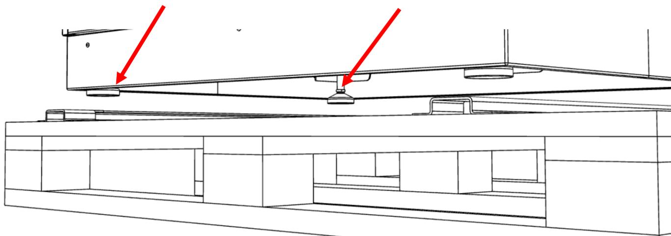
Auf der Unterseite befinden sich Ausnehmungen für Staplergabeln (Rückseite sowie seitlich). Achten Sie darauf, dass die Gabel genau in den Ausnehmungen ist, da dies ansonst zu einem Umstürzten führen kann.
