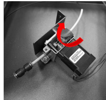
2. Falls sich das Filament nicht entfernen lässt, lösen Sie die zwei vertikalen (welche den Extruder am Halterungsaufbau halten) sowie drei seitlichen horizontal Schrauben.
