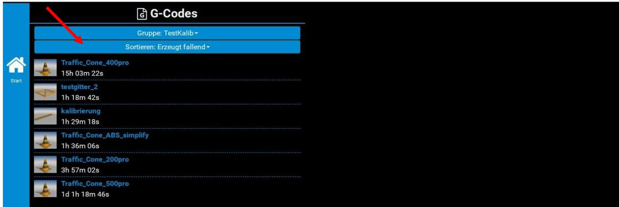
Wenn Sie den entsprechenden G-Code auswählen, werden auf der rechten Seite die entsprechenden Details angezeigt. Wenn der Drucker bereit ist erscheint der Button „Drucken“. Mit diesem können Sie den Druck starten.
