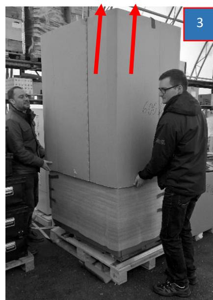
Lassen Sie die Folie und die Kantenschoner noch am EL-102. Diese schützen vorerst die Maschine vor Beschädigungen.
