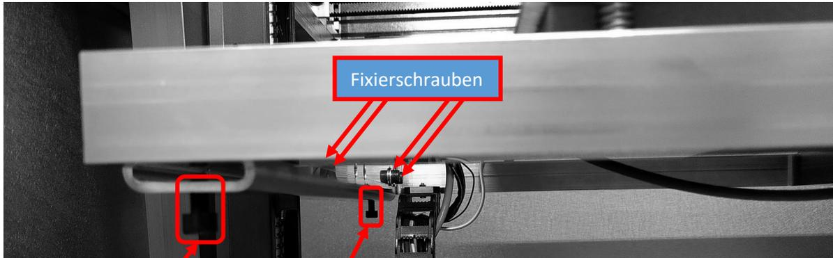
An der Unterseite des Bleches können Justierschrauben eingesetzt werden. Mit Hilfe dieser Justierschrauben können Sie das Druckbett, mit Hilfe der Messuhr ausrichten.
