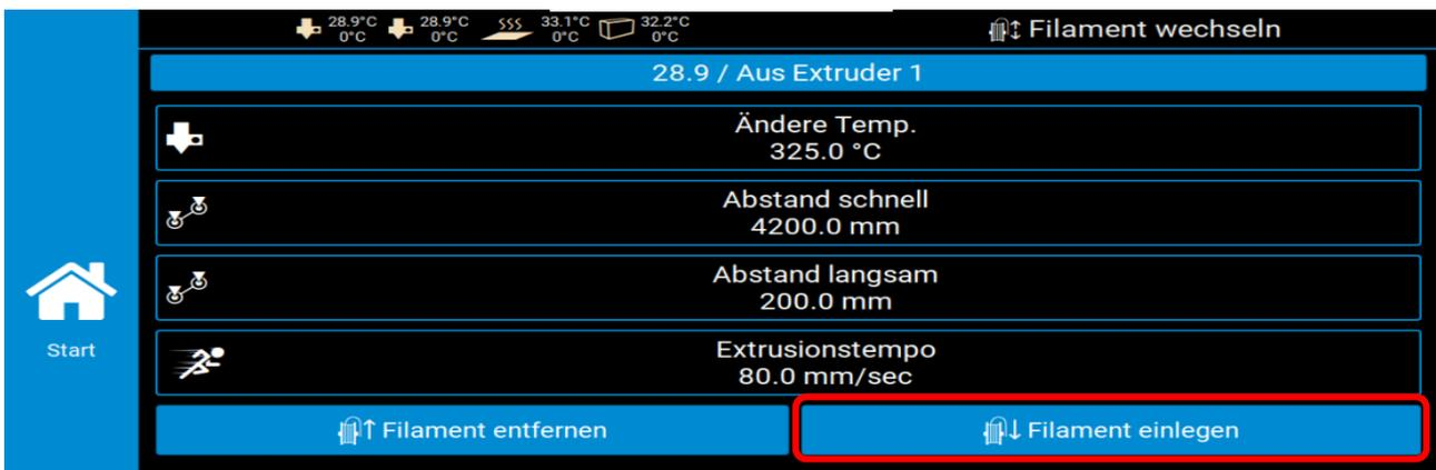
12. Das Filament kurz nach dem Bowden greifen (im Bauraum vor dem Extruderkopf) und dieses so lange einführen, bis der EL-102 es von alleine zieht. Achten Sie darauf, dass das Filament nicht knickt.
