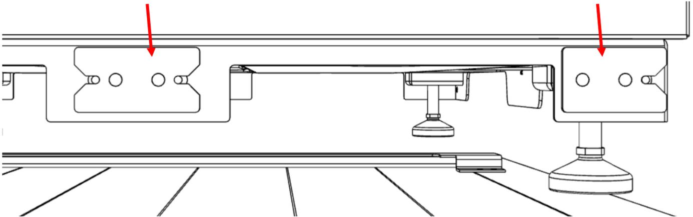
Sind diese in Position, müssen an der Vorder-bzw. Rückseite drei Schrauben angebracht werden.
